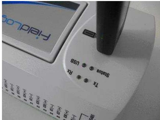
3. Recoloque el conector y el cable de alimentación del equipo y, luego, encienda el **FieldLogger**. Los **LEDs** de *status* y de la **USB** deben centellear juntos, indicando que el *bootloader* está en ejecución.
