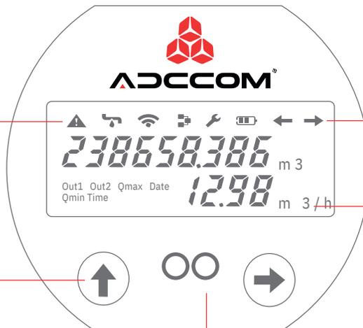
**Soporte bi-direccional del flujo de medición**
